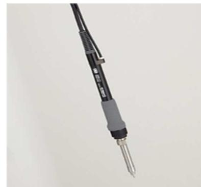
stetiger Strom von Stickstoff über den Heizkörper geleitet; der erwärmte Stickstoff tritt an der Düse des LötKolben aus, und erwärmt die Lötstelle mit Gastemperaturen zwischen 200 °C und 260 °C, abhängig von der eingestellten Solltemperatur der Lötspitze und der gewählten Gasmenge pro Zeit-
