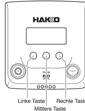
HAKKO FX-100 verfügt über 3 Betriebsstasten. Die Funktion der einzelnen Tasten hängt davon ab, was im Display angezeigt wird. Die Funktion für jede Taste wird am unteren Rand des Displays angezeigt. Wählen Sie je nach Anzeige die entsprechende Taste.
