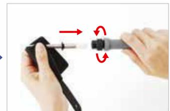
Neue Lötspitze einsetzen und die Überwurfmutter wieder anziehen.
